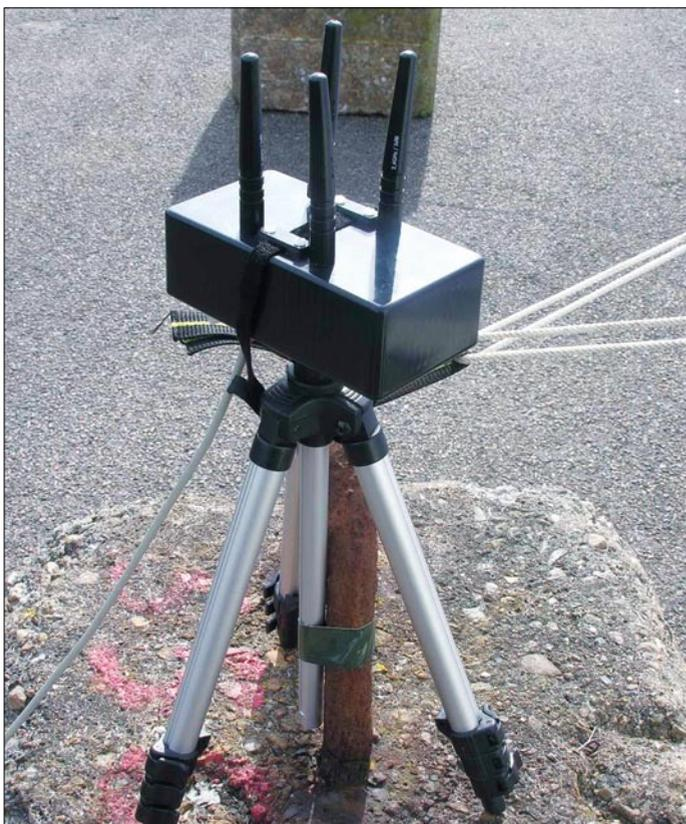
**Рис.7. 4-антенная MIMO-система связи с БПЛА**
