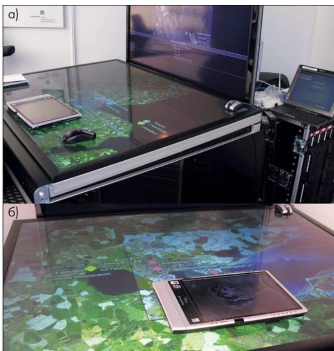
**Рис.8. Сенсорный дисплейный стол Фраунгоферского института обработки информации и данных: а) общий вид, б) планшетный ноутбук**
