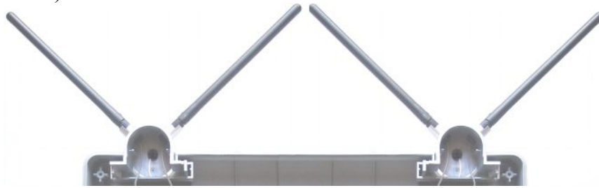
Рис. 2. Антена для роботи з ортогонально-поляризованими сигналами.
