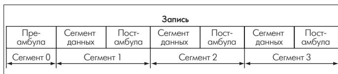
Рис. 3. Структура записи [3] (без маркеров конца сегмента и записи)
